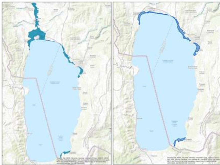
Слика 35. Хидролошко моделирање на поплавување од подземни води (лево) и поплавување на крајбрежјето од надогање на Езерото (десно).
