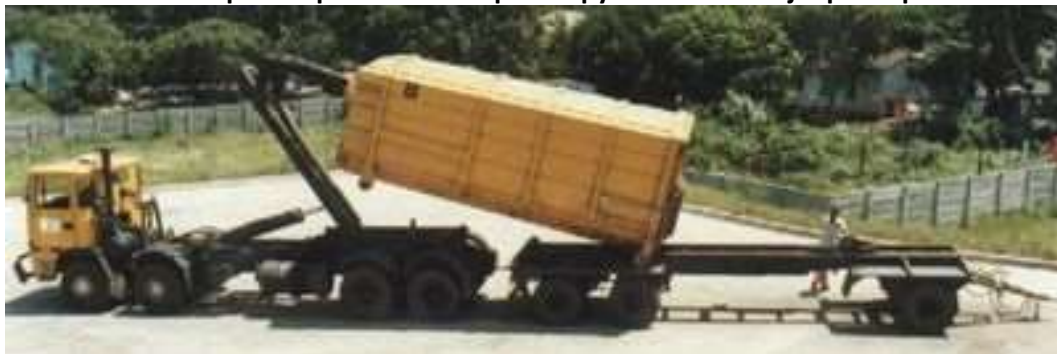
Слика 3-58: Транспортно возило претоварува полн контејнер на приколка
