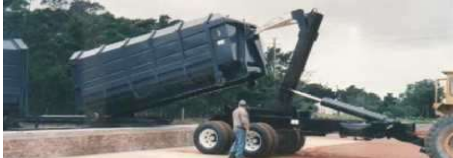
Слика 3-59: Транспортно возило претоварува полн контејнер на приколка
