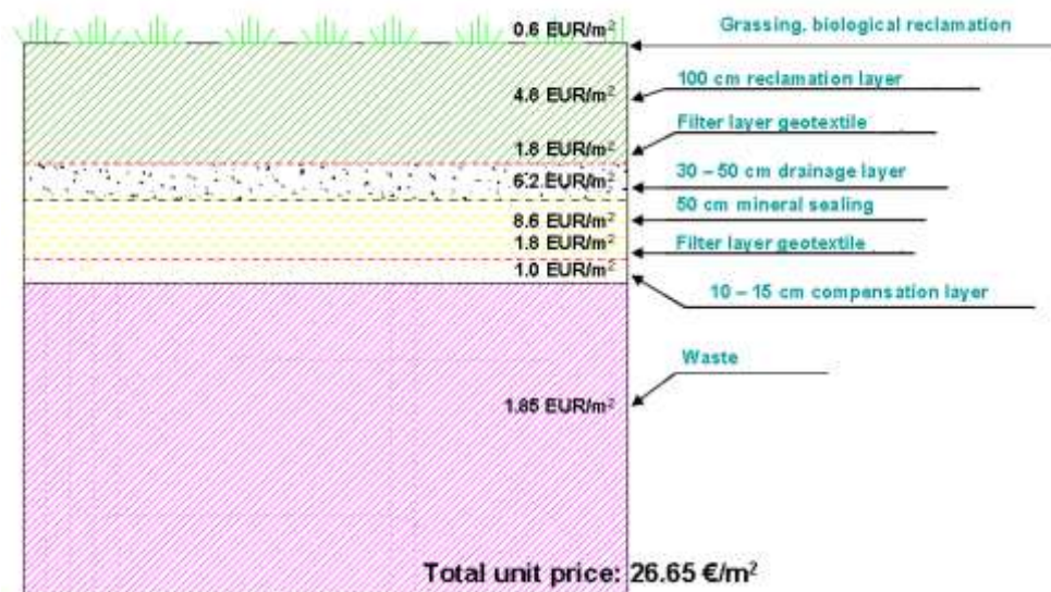
Слика 3-71: Пресек на површинско заптывање, со процена на трошоци за ЗР Модел „В“
