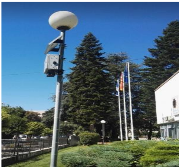
Слика бр.13. Сензор за индикативно следење на еколошки параметри за квалитет на воздухот во Охрид
